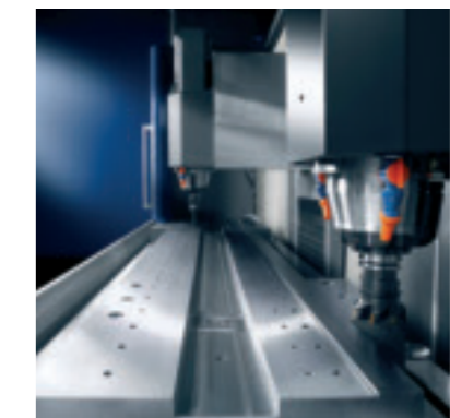
Leistungsstarke und schnelle Langbettproduktion. Hauptzeitparalleles Be- und Entladen wird durch Pendelbetrieb realisiert.
