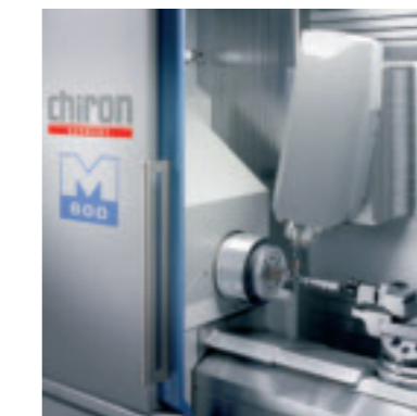
6-Seiten-Komplettfertigung von Stangenmaterial erfolgt mit multifunktionalen Fertigungszentren.
