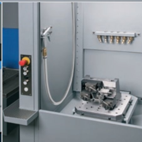
Beladepplatz für den hauptzeitparallelen Werkstückwechsel bei Serienproduktion mit kurzer Zykluszeit. Vorbildliche Ergonomie des Zugangs und der Bedienelemente.
