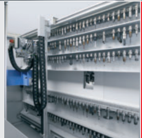
Automatischer Werkzeugwechsel im Pick-up-Verfahren ab 0,9 s mit Hintergrundmagazin für die hauptzeitparallele Bereitstellung von 177 Werkzeugen.
