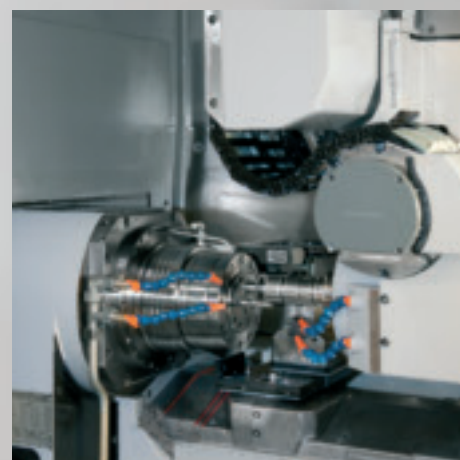
Usinage complet permettant un gain de temps considérable y compris contrôle qualité : ébavurage, mesure, consignation sur protocoles, permettent des temps pièces records de 28 minutes en moyenne.
